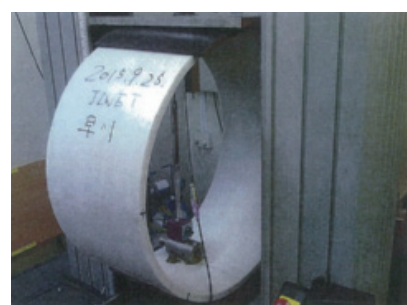
外圧試験状況
