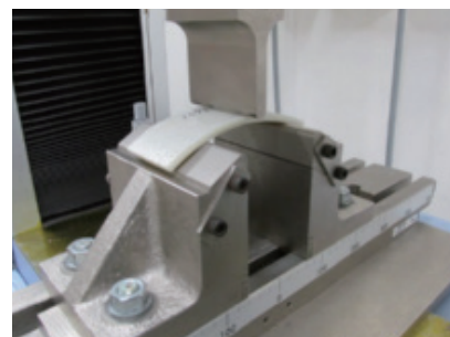
周方向短期曲げ試験状況
